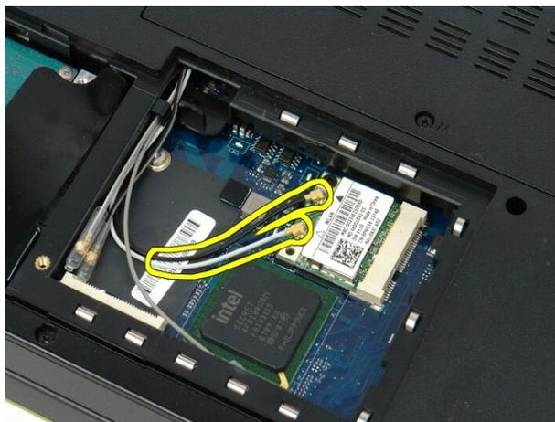
5. Выверните винт, которым плата WLAN крепится к системной плате.
