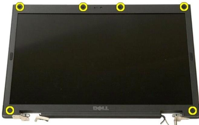
4. Выверните шесть винтов, которыми лицевая панель крепится к дисплею в сборе.
