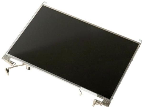
6. Выверните восемь винтов, которыми шарниры крепятся к панели дисплея в сборе.
