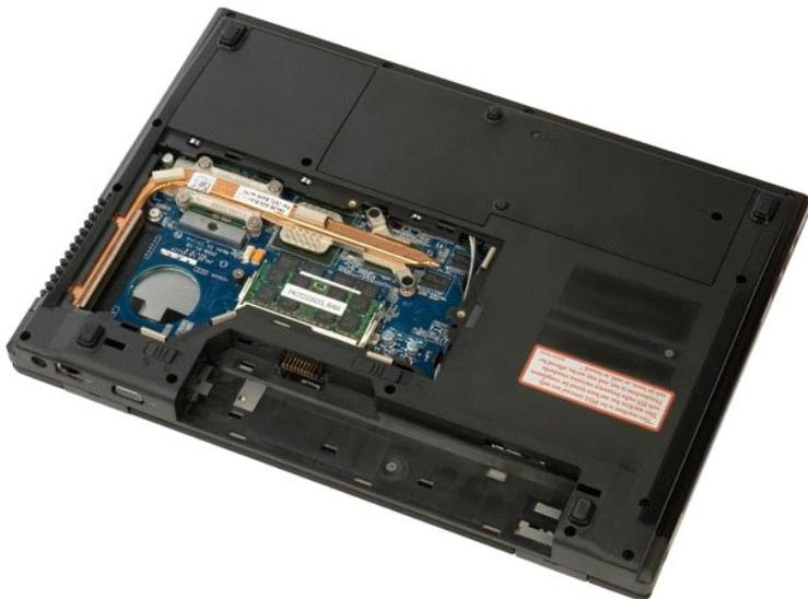
4. Подушечками пальцев осторожно раскрывайте фиксаторы с каждой стороны разъема модуля памяти до тех пор, пока модуль памяти не освободится.
