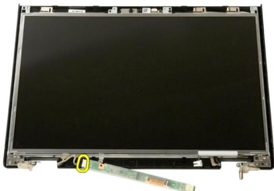
7. Извлеките инвертор дисплея из дисплея в сборе.
