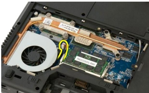
5. Выверните три винта, которыми вентилятор крепится к компьютеру.
