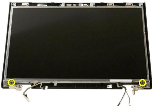
5. Извлеките панель ЖК-дисплея из дисплея в сборе.
