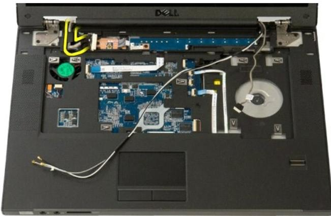
14. Выверните четыре винта, которыми дисплей в сборе крепится к основанию компьютера.
