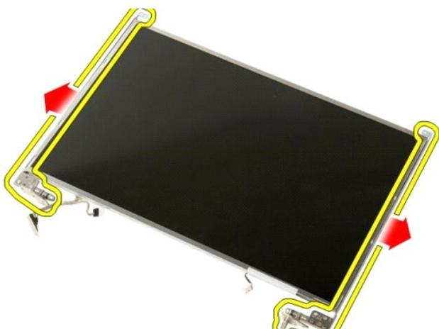
8. Извлеките шарниры панели дисплея из дисплея в сборе.
