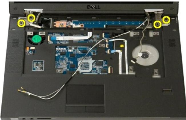
15. Приподнимите дисплей в сборе и снимите его с основания компьютера.
