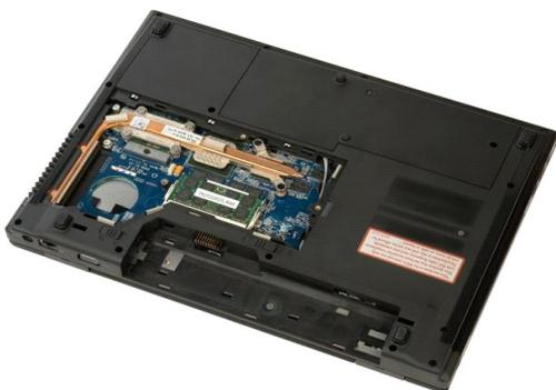
4. Выверните винт, которым оптический дисковод крепится на свое место.
