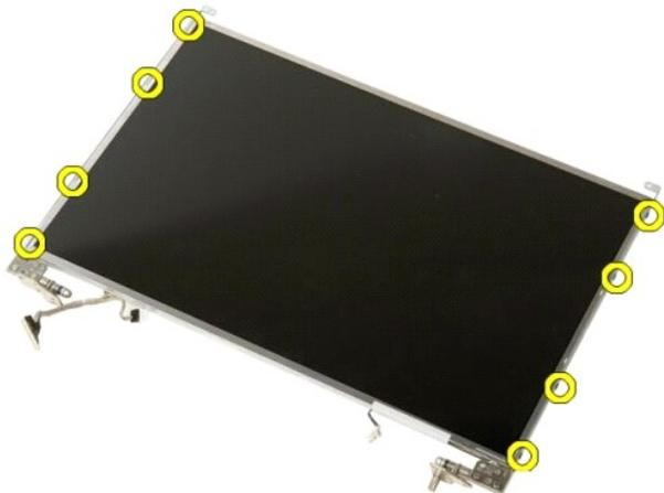
7. Сдвигайте шарниры от панели дисплея в сборе.
