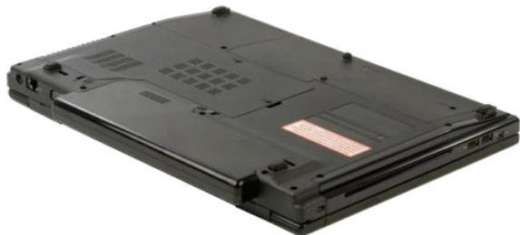
2. Сдвиньте защелку отсека аккумулятора влево от аккумулятора.
