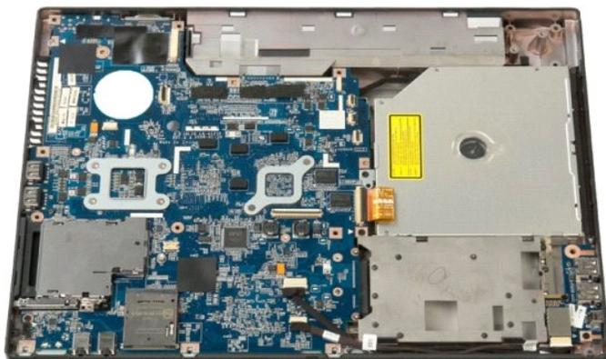
10. Выверните винт, которым модуль Bluetooth крепится к системной плате.
