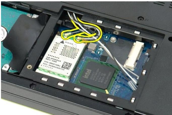
5. Выверните винт, которым плата WWAN крепится к системной плате.
