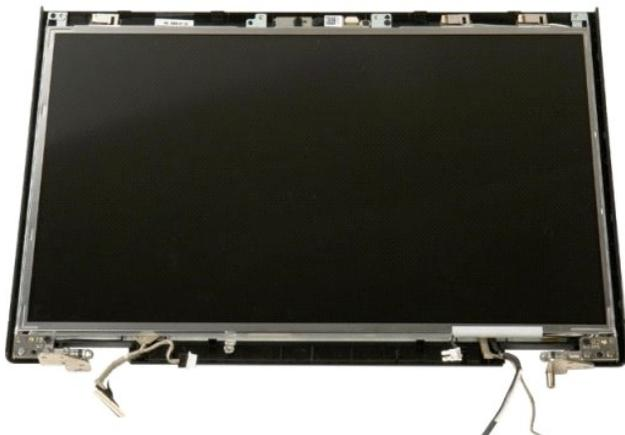
4. Выверните два винта, которыми панель ЖК-дисплея крепится к дисплею в сборе.
