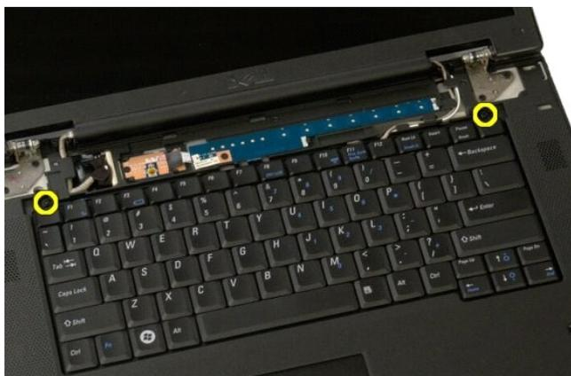
5. Приподнимите задний край клавиатуры и сдвиньте ее к задней панели компьютера.
