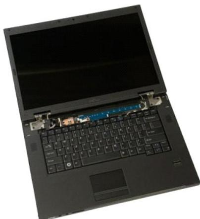
4. Выверните два винта, которыми клавиатура крепится к компьютеру.
