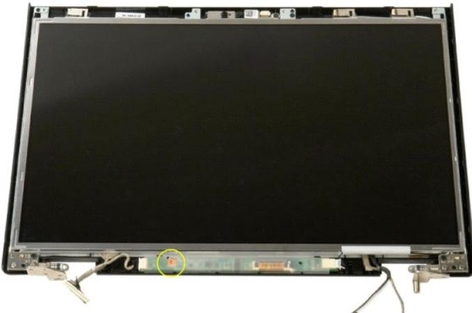
4. Откройте зажим кабеля передачи данных инвертора дисплея.
