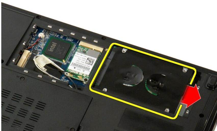
5. Поднимите жесткий диск и извлеките его из компьютера.
