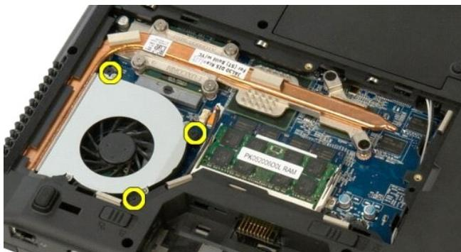
6. Приподнимите вентилятор и извлеките его из компьютера.
