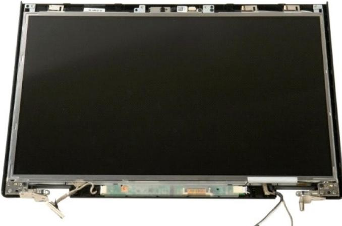
3. Выверните винт, которым инвертор дисплея крепится к дисплею в сборе.
